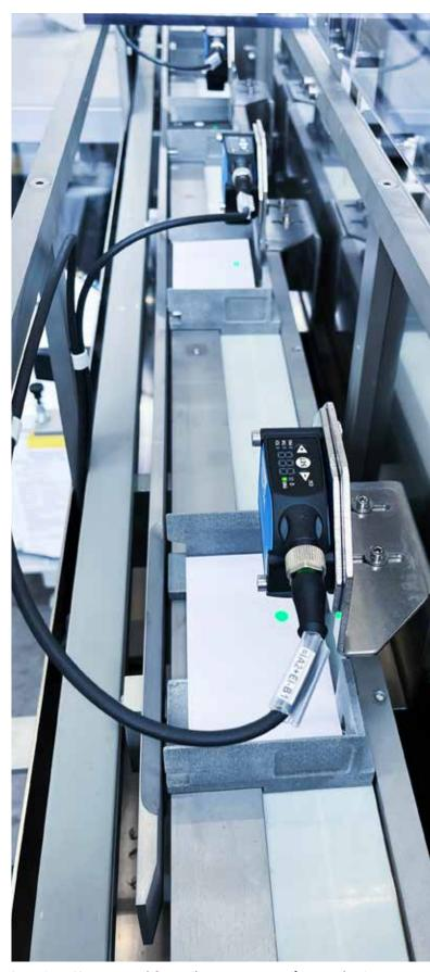
Integrierte Kamera- und Sensoriksysteme sorgen für zuverlässige Prozesskontrolle und gewährleisten eine gleichbleibend hohe Verpackungsqualität.
