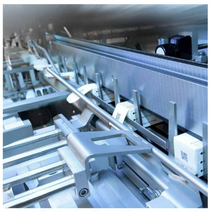
Automatische Längsverstellung des Kettenvorschubs und elektronisch-digitale Stellungsanzeiger gewährleisten eine sichere Formatumstellung.
